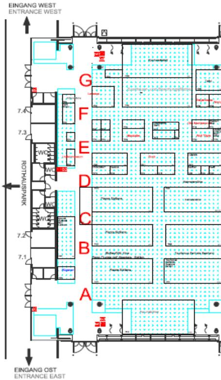
ZULÄSSIGE BELASTUNG SPARTENKANÄLE: 16 kN/m<sup>2</sup>
